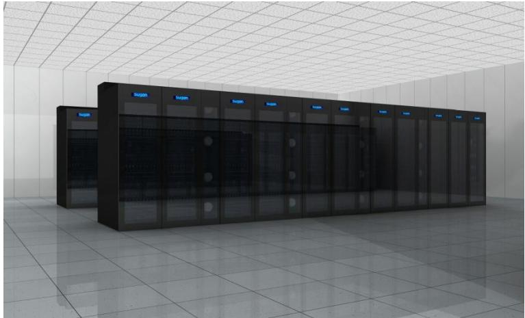
**C**3000 机柜排级机房基础设施系统，是曙光公司为解决高密度刀片服务器散热问题所推出的以机柜排为单位，封闭风道的，以冷冻水为冷媒，包含机柜、配电、制冷、监控等四个子系统的整体解决方案。
